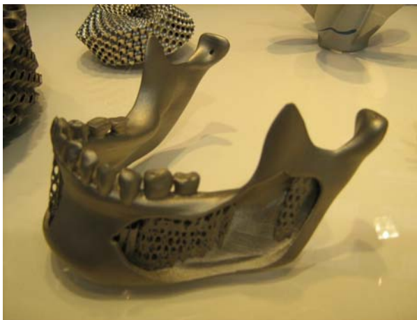
Figura 9. Exemplu de complexitate geometrica realizata pentru domeniul cranio-maxilo-facial
