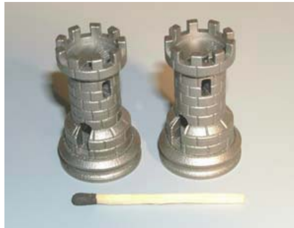
Figura 1. Exemplu de piese de test EOSINT M 270 (aceste piese au si o structura interioara sub forma de scara in spirala ascendenta)
